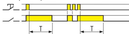
**(IP) Telerruptor temporizado con preaviso de apagado**
