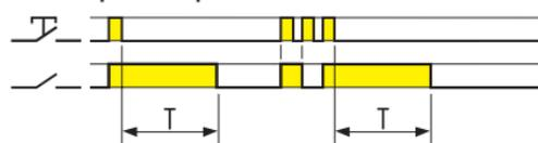
**(IP) Relé a impulsi temporizzato con preavviso di spegnimento**
