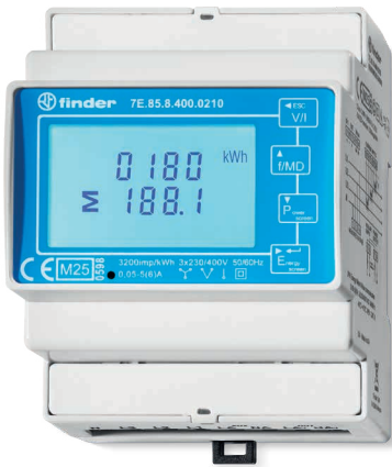
Type 7E.85.8.400.0210 (Enkeltarief) Type 7E.85.8.400.0212 (Dubbeltarief) Modbus RS485 + 2 S0
