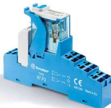
Tipo 4C.P2 2 contactos conmutados 8 A 250 V AC1
