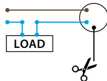
Conectando el hilo marrón y el azul, el circuito abre cuando el flotador está arriba y cierra cuando el flotador está abajo. En este caso, se debe aislar el hilo negro.
