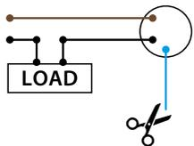
Conectando el hilo negro y el marrón, el circuito cierra cuando el flotador está arriba y abre cuando el flotador está abajo. En este caso, se debe aislar el hilo azul.
