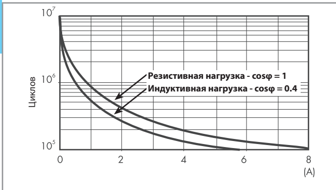
RR - Электрическая долговечность (AC) при ном. нагрузке
