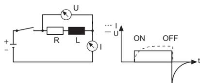
**Comutação das bobinas de relé.**
