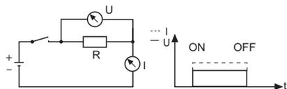
Característica da tensão/corrente durante a comutação da bobina de relé (fig. 2).
