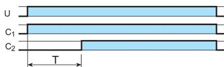
**(AI b) Atraso à operação****(1 contato retardado + 1 instantâneo).**Aplicar tensão no temporizador. A excitação do relé  $C_1$  ocorre imediatamente.O relé  $C_2$  se excita depois de transcorrido o tempo pré-ajustado.
