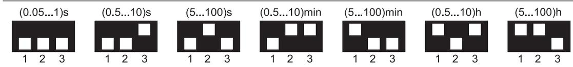
Achtung: Ein Wechsel der Funktion oder des Zeitbereiches unter Betriebsspannung führt zur Fehlfunktion, ggf. kurz spannungsfrei machen
