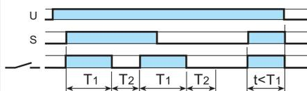
**(LE) Accionamiento intermitente asimétrico (inicio trabajo) con alimentación auxiliar.**
