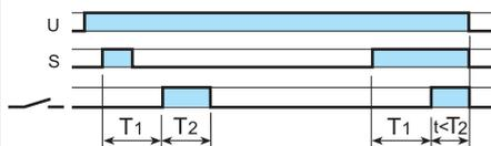
**(PE) Accionamiento intermitente asimétrico (inicio reposo) con alimentación auxiliar.**
