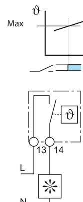
**Contrôle du chauffage** - Lorsque la température de l'armoire chute au dessous de la valeur minimale sélectionnée, le contact se fermera pour demander du chauffage. Le contact s'ouvrira lorsque la température dépassera la valeur sélectionnée.
