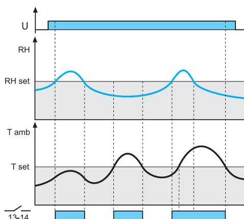
**HT : RH > RH<sub>set</sub> ou T<sub>amb</sub> > T<sub>set</sub>**
