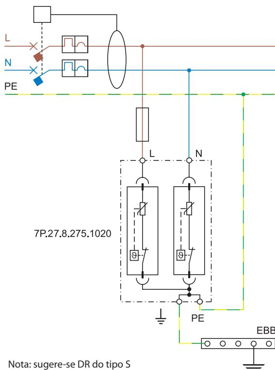
**Exemplo de esquema de instalação para DPS Tipo III**
