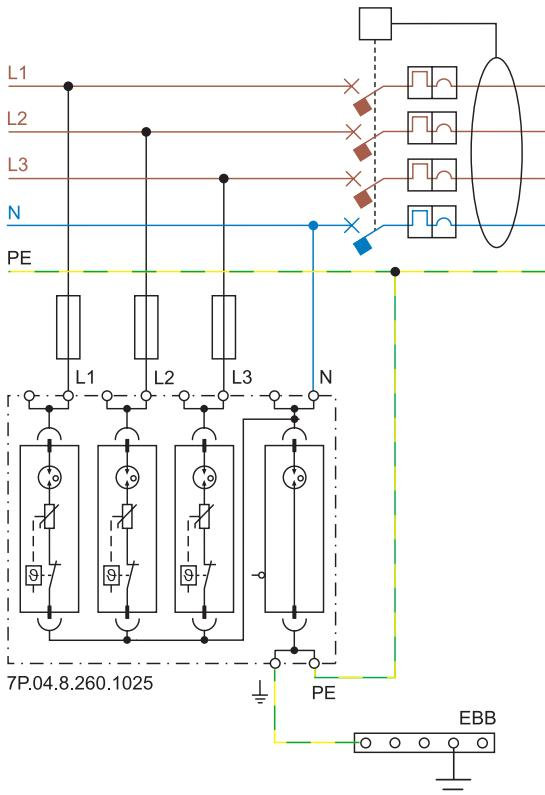
Esquema de ligação "V-shape" (fusível máx. = 125 A)
