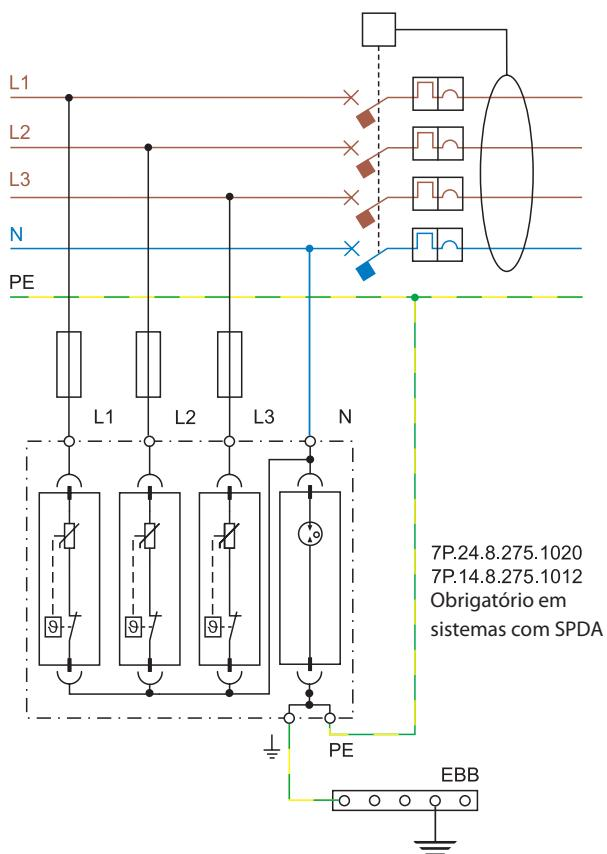
TT ou TN-S - SISTEMA TRIFÁSICO - DPS INSTALADO DEPOIS DO DR
