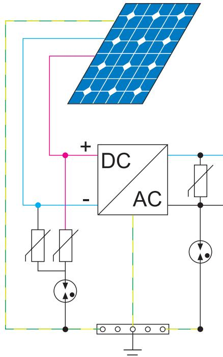
Figura 10: Esquema simplificado de uma instalação fotovoltaica instalada sobre um edifício sem SPDA, protegido pelo lado DC com DPS com U<sub>OCSTC</sub> = 420 V, e pelo lado AC com um 7P.22 específico para sistemas de aterramento TT.
