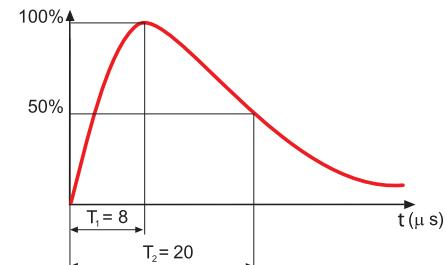
Figura 6: Forma de onda de corrente 8/20  $\mu s$
