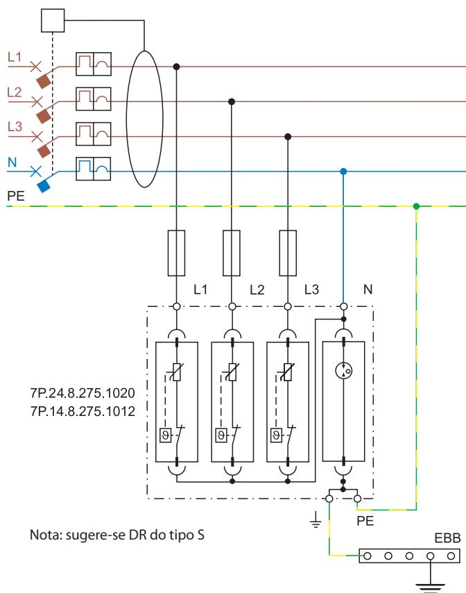
TN-S - SISTEMA TRIFÁSICO - DPS INSTALADO DEPOIS DA PROTEÇÃO
