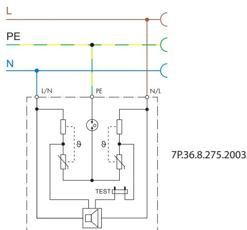
Exemplos de esquemas de instalação para DPS Tipo I+II e Tipo II - Trifásico
