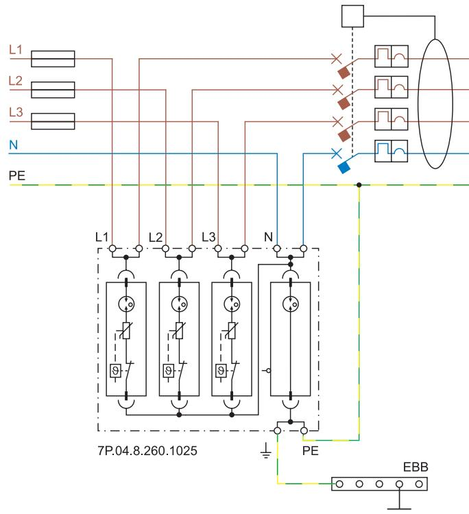
**Exemplos de esquemas de instalação para DPS Tipo I+II e Tipo II - Monofásico**
