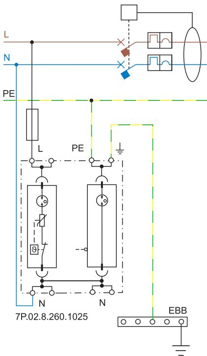
TT - SISTEMA TRIFÁSICO - DPS INSTALADO ANTES DO DR
