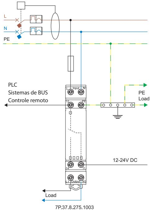
TT, TN-S - SISTEMA MONOFÁSICO: conexão em paralelo
