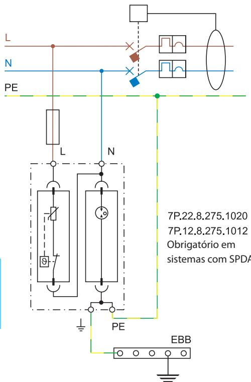
TT ou TN-S - SISTEMA MONOFÁSICO - DPS INSTALADO DEPOIS DO DR
