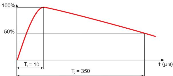
Figure 5 : forme d'onde de courant 10/350 µs
