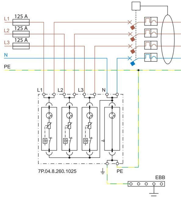
Pour les systèmes dans lesquels le courant nominal est supérieur à 125A, on doit réaliser une installation classique du SPD en parallèle du système (T\_shape).
