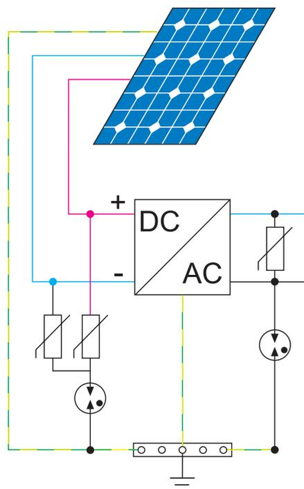
Figure 10 : schéma d'une installation photovoltaïque sur un bâtiment sans paratonnerre, protégée sur le coté DC par un parafoudre avec  $U_{OCSTC} = 420 V$ , et sur le coté AC par un 7P.22 spécifique pour installation schéma TT.
