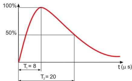
Figure 6 : forme d'onde de courant 8/20µs
