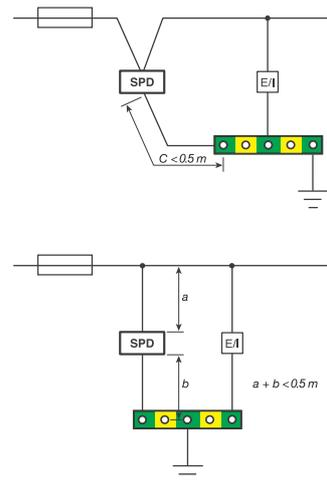
La section des conducteurs de raccordement (en cuivre) ne doit pas être inférieure à :
