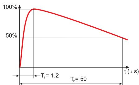
Figure 7 : forme d'onde de tension 1.2/50 µs
