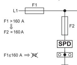
La protection des parafoudres contre les courts circuits est donnée par des dispositifs tels que fusibles type gL/gG qui doivent être sélectionnés selon les informations données par le constructeur du parafoudre. Dans les applications en AC, si le dispositif de protection principale, fusible F1 dans le schéma ci-dessus, a un calibre inférieur ou égale au maximum recommandé par le dispositif de protection contre les surintensité (fusible F2), F2 n'est pas nécessaire.
