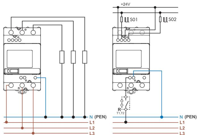
**Compteur d'énergie multifonction bidirectionnel avec écran LCD rétro-éclairé. Certifié MID à 80 A, 70°C pour systèmes monophasés et triphasés à 3 ou 4 fils @ 70°C**
