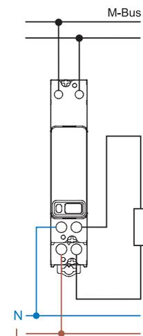
**Compteur d'énergie multifonction bidirectionnel avec écran LCD rétro-éclairé. Certifié MID à 80 A, 70°C pour systèmes monophasés et triphasés à 3 ou 4 fils @ 70°C**
