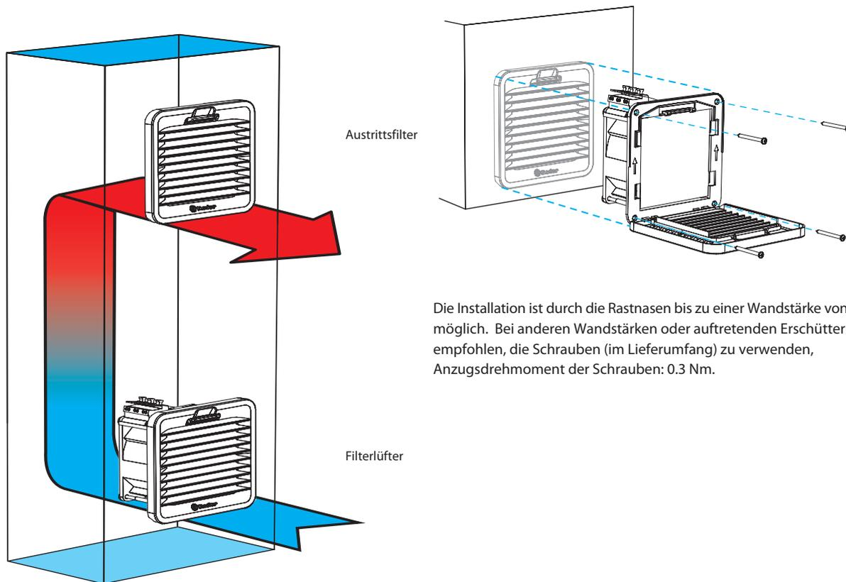
Die Installation ist durch die Rastnasen bis zu einer Wandstärke von 1.0...2.5 mm möglich. Bei anderen Wandstärken oder auftretenden Erschütterungen wird empfohlen, die Schrauben (im Lieferumfang) zu verwenden, Anzugsdrehmoment der Schrauben: 0.3 Nm.
