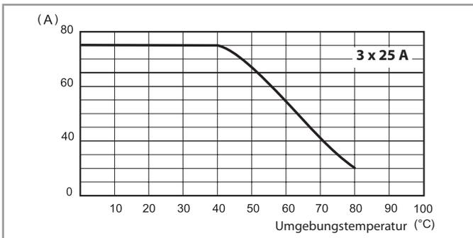
1 - Montage auf Kühlkörper (0.7 K/W)
