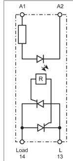
**Elektronisches Relais (SSR), 7 - 15 A mit DC-Ausgang**
