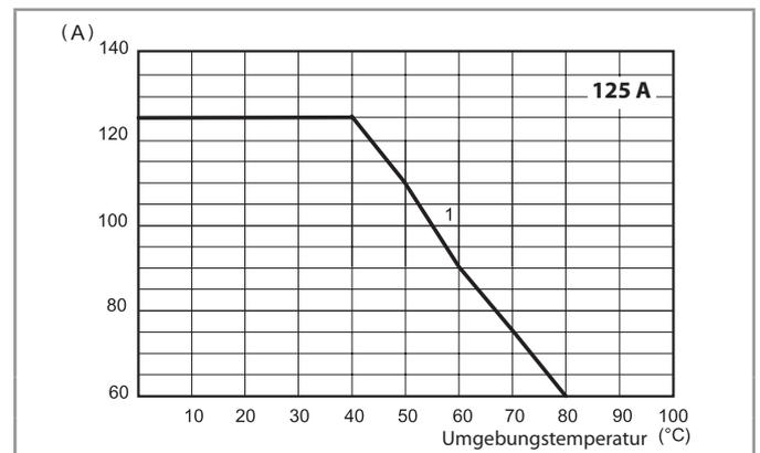
1 - Montage auf Kühlkörper (0.35 K/W)
