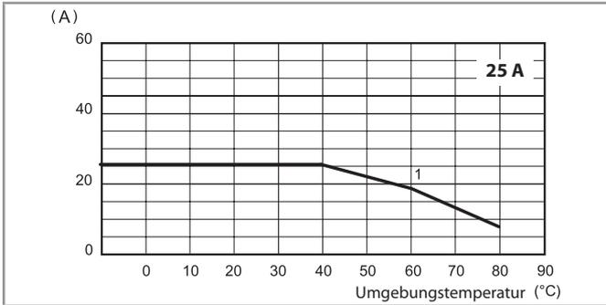
1 - Montage auf Kühlkörper (2 K/W)
