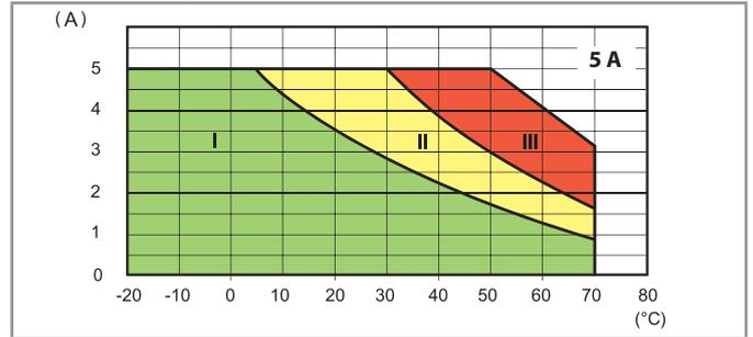
**L77-3 Ausgangsbelastbarkeit** - Dauerstrom in Abhängigkeit von der Umgebungstemperatur, **77.01.9.024.9024 bei 32 V DC**
