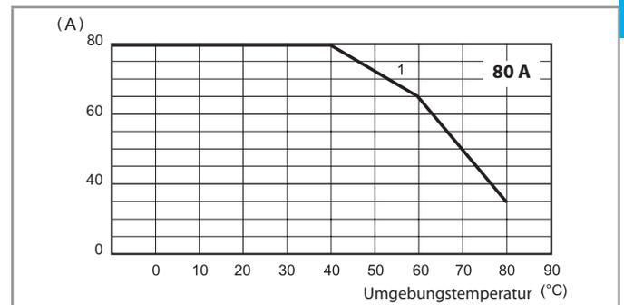
1 - Montage auf Kühlkörper (0.5 K/W)
