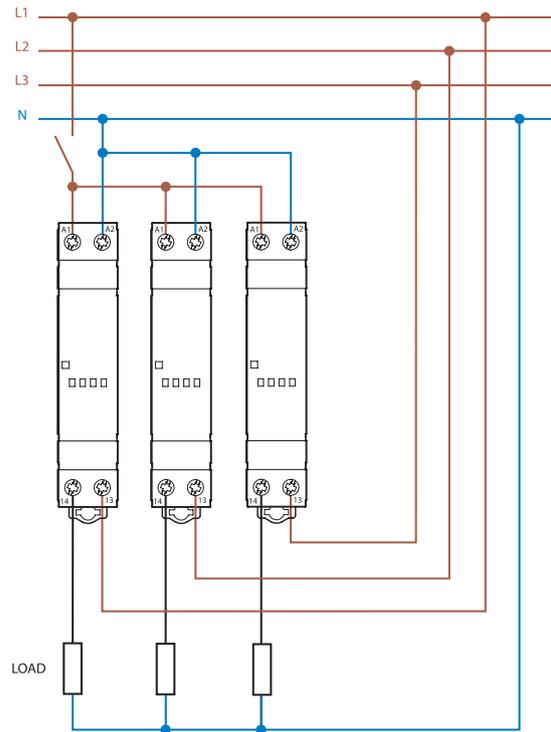
Anmerkung: Der dargestellte Anschluss von 3-phasigen Lasten ist mit allen Typen der Serie 77 möglich.
