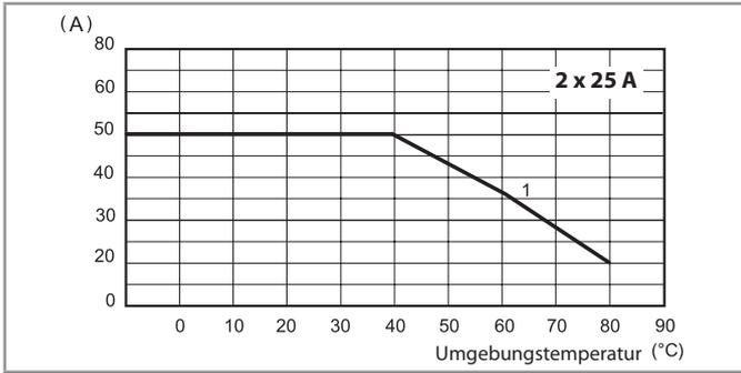
1 - Montage auf Kühlkörper (0.9 K/W)
