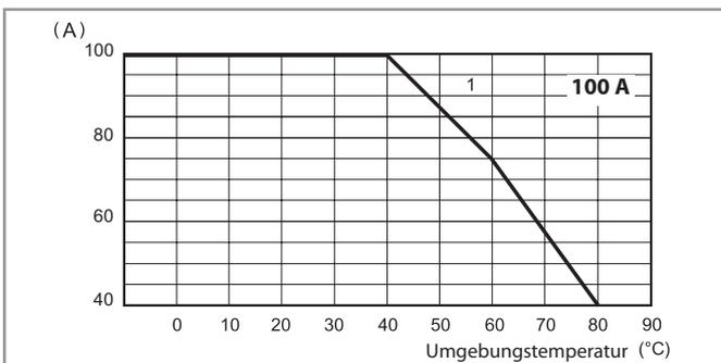
1 - Montage auf Kühlkörper (0.45 K/W)
