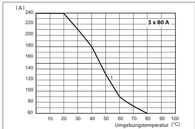
1 - Montage auf Kühlkörper (0.35 K/W)
