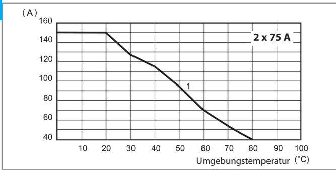
1 - Montage auf Kühlkörper (0.45 K/W)
