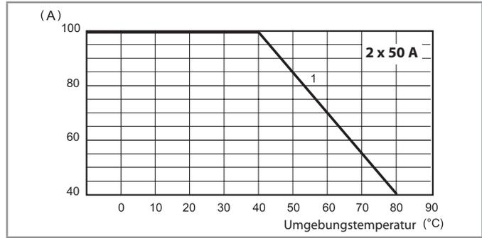
1 - Montage auf Kühlkörper (0.45 K/W)
