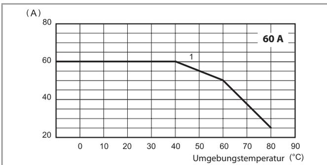
1 - Montage auf Kühlkörper (0.7 K/W)
