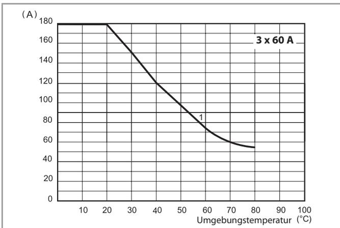
1 - Montage auf Kühlkörper (0.45 K/W)
