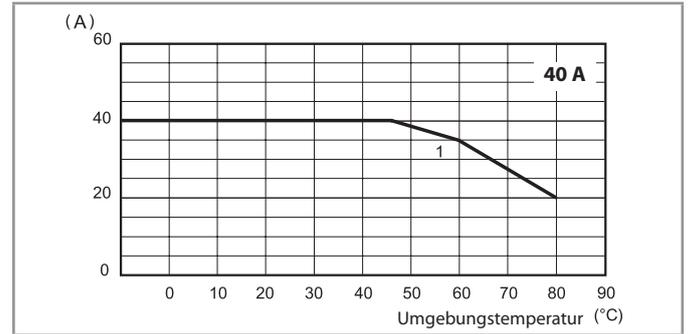
1 - Montage auf Kühlkörper (0.9 K/W)
