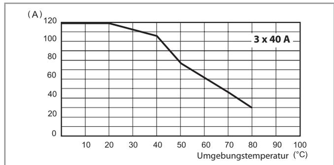
1 - Montage auf Kühlkörper (0.5 K/W)
