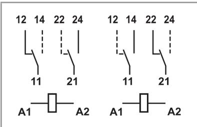
Nach EN 61810-3 (Typ B) dürfen als zwangsgeführte Kontakte nur ein Öffner und ein Schließer (11-12 und 21-24 oder 21-22 und 11-14) genutzt werden.
