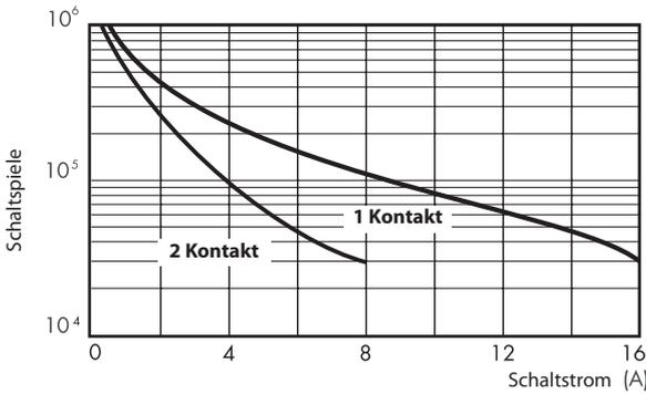
**H 41 - Gleichstromschaltvermögen bei DC1 - Belastung**
