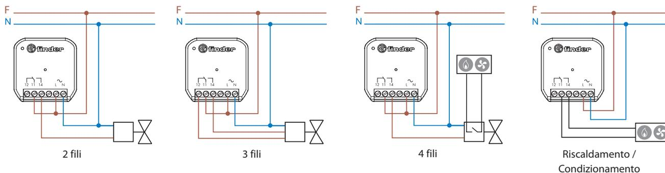
Esempio di collegamento con elettrovalvole a 230 V AC, in ogni caso fare riferimento alle caratteristiche tecniche delle elettrovalvole utilizzate.
