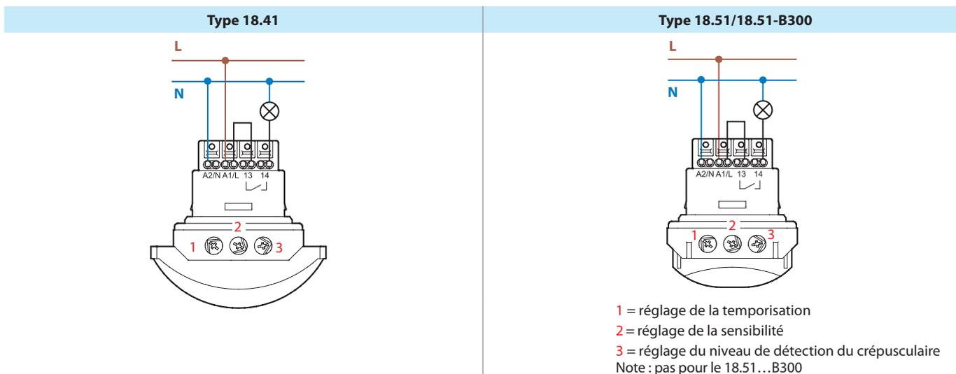
La puissance nominale indiquée dans les spécifications pour la commutation de lampes s'entend si le raccordement est effectué selon les schémas ci-dessus. Si les lampes sont alimentées par une phase différente de celle alimentant le détecteur de mouvement, il faut alors réduire de 50% la puissance des lampes à commuter.
