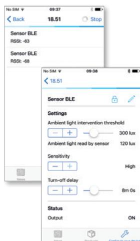
Les détecteurs peuvent être identifiés à l'intérieur d'un bâtiment. Le seuil de luminosité peut être réglé entre 4 et 1000 lux et la plage de retard à l'extinction va de 12 secondes à 25 minutes. Les détecteurs possèdent également 3 niveaux de sensibilité réglables.
