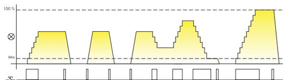
**Comando con impulsi lunghi** (tramite pressione del pulsante): regolazione a 10 gradini dell'intensità luminosa, in aumento o in diminuzione.
