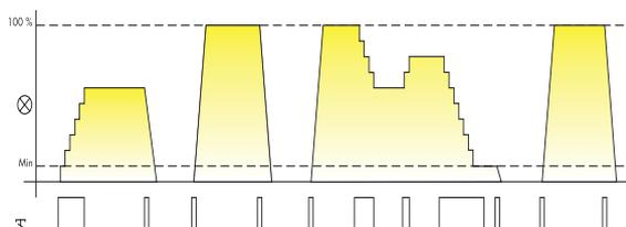
**Comando con impulsi lunghi** (tramite pressione del pulsante): regolazione a 10 gradini dell'intensità luminosa, in aumento o in diminuzione.
