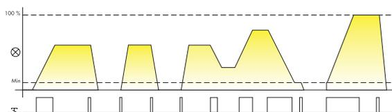
**Comando con impulsi lunghi (tramite pressione del pulsante):** regolazione lineare dell'intensità luminosa, in aumento o in diminuzione.
