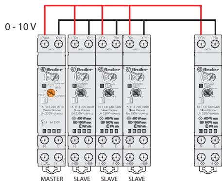
Il nuovo sistema è modulare, adattabile ad ogni esigenza e permette il controllo delle lampade con un solo dispositivo di comando detto Master Dimmer codice 15.10.8.230.0010.
