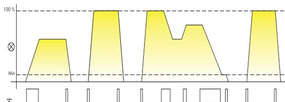
**Comando con impulsi lunghi** (tramite pressione del pulsante): regolazione lineare dell'intensità luminosa, in aumento o in diminuzione.
