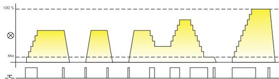
**Commande par impulsions longues (par pression sur un poussoir)** : réglage de l'intensité lumineuse croissante ou décroissante en 10 paliers.
