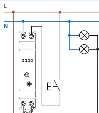
Schémas de raccordement
