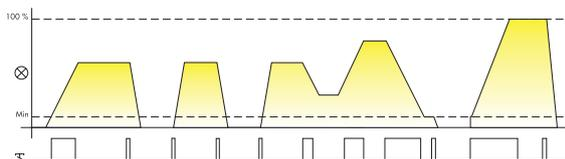
**Commande par impulsions longues** : l'intensité lumineuse est progressivement augmentée ou diminuée.
