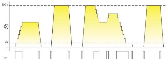
**Commande par impulsions longues (par pression sur un poussoir)** : réglage de l'intensité lumineuse croissante ou décroissante en 10 paliers.
