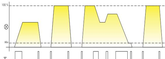
**Commande par impulsions longues** : l'intensité lumineuse est progressivement augmentée ou diminuée.
