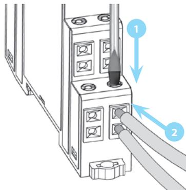
Connessione con cavo flessibile (senza cacciavite in caso di filo rigido)
