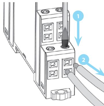
Disconnessione del collegamento elettrico
