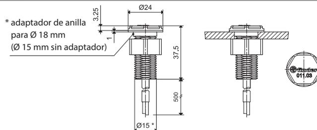
\* adaptador de anilla para  $\text{Ø} 18 \text{ mm}$  ( $\text{Ø} 15 \text{ mm}$  sin adaptador)
