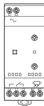
**Relé para el encendido de lámparas en función de la luminosidad ambiental, se suministran con sensor fotosensible externo**
