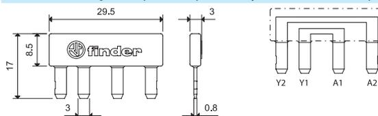
Para la conexión directa de la salida auxiliar del 11.91 (Y1-Y2) a los terminales de alimentación del 19.91 (A1-A2)
