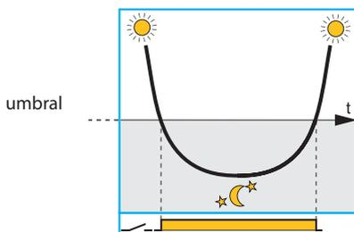
Funcionamiento correcto - siempre y cuando el sensor fotosensible se pueda proteger de los efectos del encendido y apagado de la luminaria que conecta
