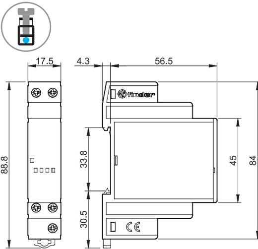
Typ 11.91 + 19.91 (Dämmerungsschalter mit Brücke 011.19 + Ausgangsmodul)
