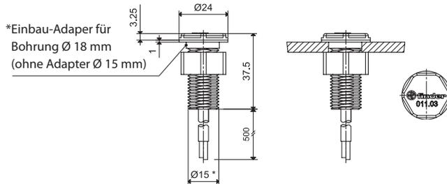
\*Einbau-Adapter für Bohrung Ø 18 mm (ohne Adapter Ø 15 mm)
