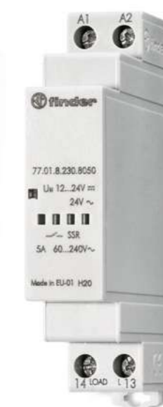
IDEAL FÜR LED LASTEN MIT EINSCHALTSTRÖMEN BIS ZU 300 A Typ 77.01
