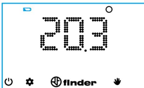
Bei Erreichen des zweiten Schwellwertes, schaltet das Chronothermostat ab. In diesem Modus ist keine Beeinflussung des Displays möglich und das Relais ist deaktiviert.
