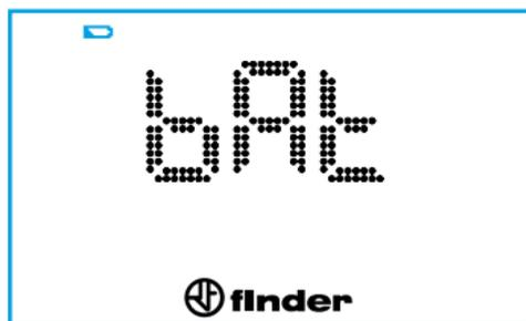
Nach dem Einschalten des Displays, durch berühren der Finder Taste, blinkt das Batteriesymbol weiter.
