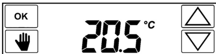
Impostata la temperatura e confermato con **OK** il cronotermostato avvia la funzione (il display mostra, sul lato destro, una sequenza di mani che scorrono dall'alto verso il basso).
