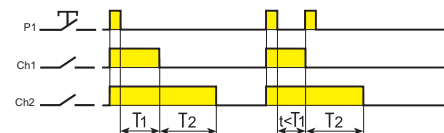
(VB) Eclairage de salle de bain + ventilation
