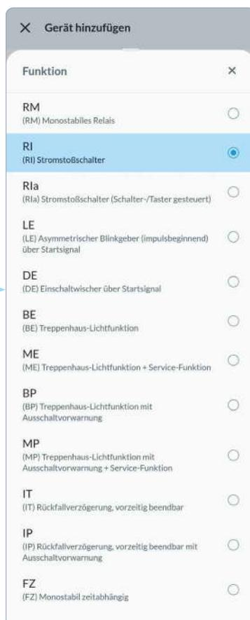
Sie haben eine große Auswahl an Funktionen wie Stromstoßschalter (Taster- oder Schaltersteuerung), Treppenhauslicht, Blinker und vieles mehr. Klicken Sie auf **“Mehr entdecken“** für weitere Informationen und Bilder.
