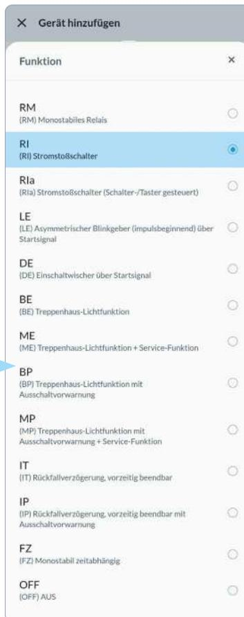
Die "separate" Nutzung der Kanäle bietet eine große Auswahl an Funktionen wie Stromstoßschalter (nur Tastergesteuert), Treppenhauslicht, Einschaltwischer (DE, min. 2 s) und viele andere. Klicken Sie auf "Mehr entdecken" für weitere Informationen und Bilder.
