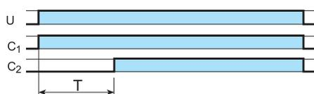
**(AI b) Temporisé à la mise sous tension****(1 contact retardé + 1 contact instantané)**
