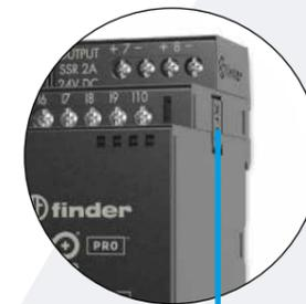
Conexión a través del puerto auxiliar AUX
