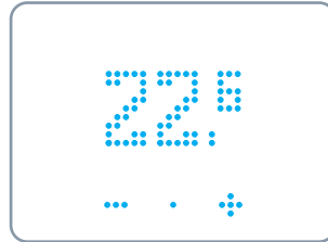
UMGEBUNGSTEMPERATUR Der Thermostat wird in den Modus AUTOMATISCH (AUTO) versetzt und folgt der Programmierung der App.
