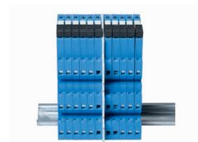
2. Lasciando le nervature si può ottenere una separazione di 6.2 mm. Tagliando le relative sezioni con delle semplici forbici, è possibile una interconnessione attraverso il separatore di 2 gruppi di interfacce, utilizzando il pettine di collegamento.
