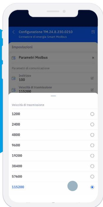
Cambiamo la velocità di trasmissione da 19200 a 115200
