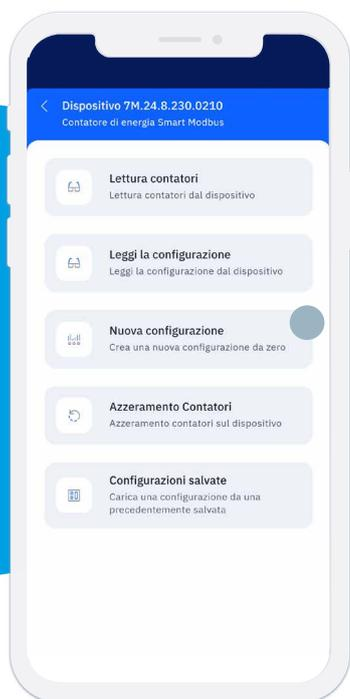
“Nuova Configurazione” contiene le impostazioni “di fabbrica” da poter inviare al 7M per ripristinarlo o da modificare a seconda delle nuove esigenze.
