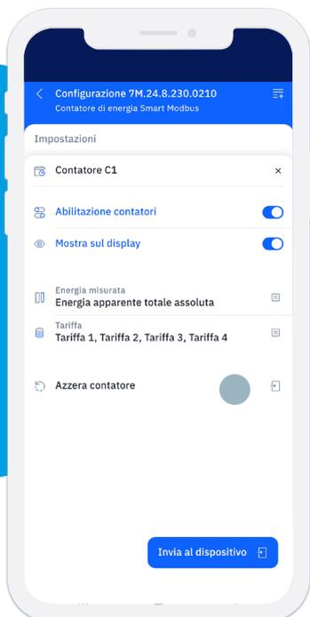
In caso volessimo azzerare il contatore C1, basterà selezionare "Azzera contatore" appoggiando lo smartphone sul display del 7M.
