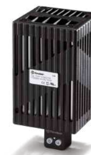
Typ 7H.51.0.230.0100 Moc grzałki 100 W Wymiary (szer. x wys. x gł.): 70 x 140 x 63 mm
