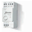
Typ 13.01 Elektroniczny przekaźnik bistabilny/ monostabilny - 1 P, 16 A 250 V AC - Napięcie zasilania: AC lub DC - Do montażu na szynę DIN 35 mm (EN 60715)
