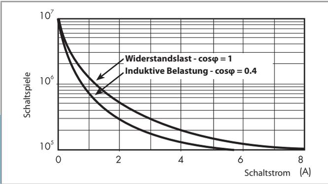
H 50 - Gleichstromschaltvermögen bei DC1 - Belastung (Typ 50.12)
