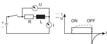
При подаче напряжения на катушку образуются электродвижущая сила, и нарастание тока происходит с задержкой по времени. При прекращении подачи напряжения на катушку происходит скачкообразное уменьшение величины магнитного поля, которое в свою очередь, вызывает всплеск напряжения обратной полярности на катушке. Этот всплеск может достигать значений, в 15 раз превышающих номинальное напряжение, что может помешать нормальной работе электронных устройств, вплоть до их разрушения.
