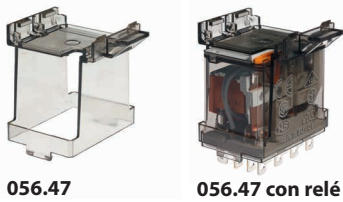
Adaptador con aletas en carril 35 mm (EN 60715) en la parte superior para relé tipo 56.34
