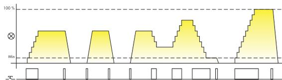
**Pulso de mando prolongado:** el nivel de luz aumenta o disminuye progresivamente de forma lineal a través de un máximo de 10 pasos graduales.
