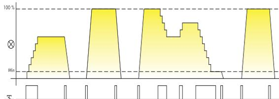
**Pulso de mando prolongado:** el nivel de luz aumenta o disminuye progresivamente de forma lineal a través de un máximo de 10 pasos graduales.
