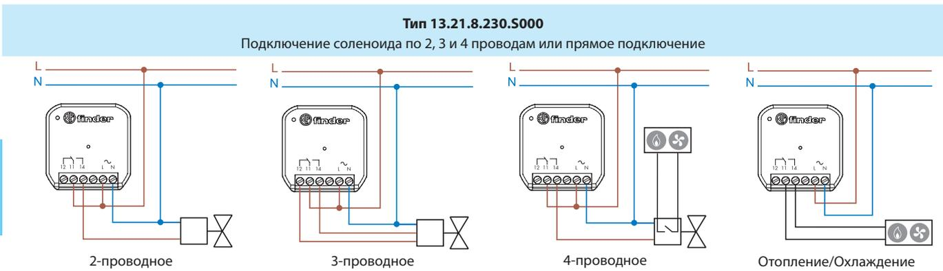
Пример подключение соленоидного клапана 230 В АС. Всегда выполняйте технические характеристики соленоидного клапана.
