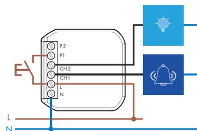
**Тип 13.22 - специальная функция RiA - Шаговое реле (управление выключателем освещения).**
