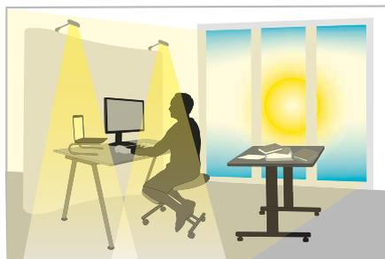
Con luminosità sufficiente e con rilevazione del movimento, il 18.51 mantiene le lampade spente.
