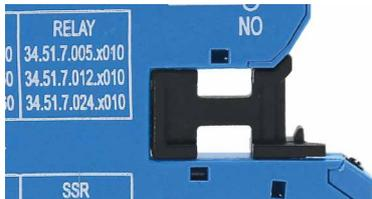
1. In caso di utilizzo del modulo porta fusibile, è sufficiente rimuovere il modulo di connessione e sostituirlo con il porta fusibile. Il fusibile è collegato elettricamente in serie con il terminale comune dell'interfaccia (11 per le versioni EMR, 13+ per le versioni SSR, 15 per il temporizzatore EMR, 15+ per il temporizzatore SSR).
