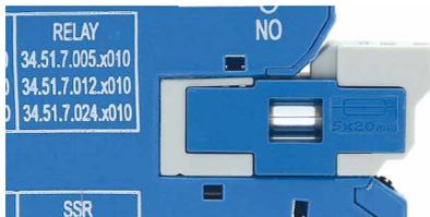
2. Se il modulo porta fusibile viene estratto (per esempio perchè il fusibile è interrotto) l'uscita del circuito sarà bloccata in posizione aperta, in una condizione di "sicurezza".
