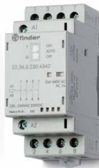
A 22-es sorozatú mágneskapcsolók, AgSnO_2 érintkezőanyaggal, nagy az érintkezők bekapcsolási áramokkal szembeni hegedésállósága, a névleges tekerccsfeszültség (AC/DC) széles tartományban választható
