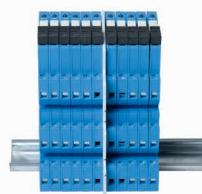
2. Manteniendo la pestañas en su lugar proporciona una separación de 6.2 mm. Con un simple corte (con tijera) del segmento/segmentos pertinente, permite la interconexión a través del separador de 2 grupos diferentes de interfaces, utilizando los puentes estándar.
