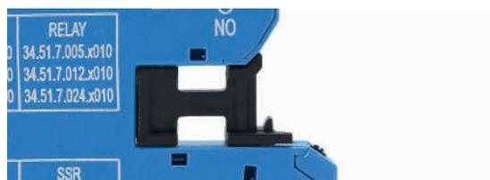
1. In caso di utilizzo del modulo porta fusibile, è sufficiente rimuovere il modulo di connessione e sostituirlo con il porta fusibile. Il fusibile è collegato elettricamente in serie con il terminale comune dell'interfaccia (11 per le versioni EMR, 13+ per le versioni SSR, 15 per il temporizzatore EMR, 15+ per il temporizzatore SSR).
