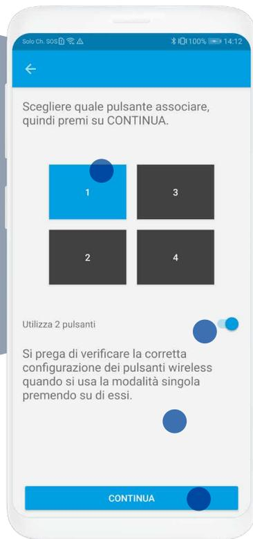
Con il dimmer 15.71 è possibile accoppiare due canali del pulsante wireless adibendo quello in alto solo alla dimmerazione crescente e quello in basso alla dimmerazione verso lo zero.
