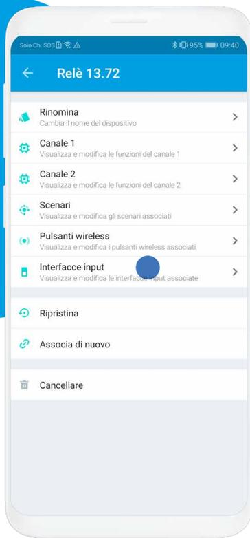
Per associare l'interfaccia input a qualsiasi dispositivo è necessario entrare nel dispositivo a cui si vuole associare e premere su 'Interfacce input'.
