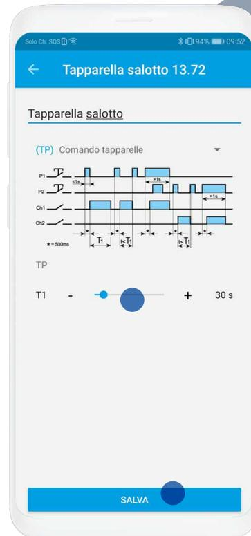
NB: Cablare il Canale 1 per la salita della tapparella ed il Canale 2 per la discesa.
