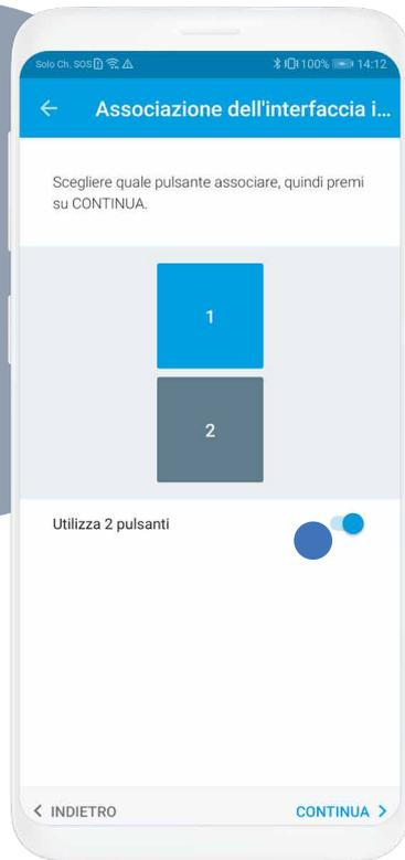
Con il dimmer 15.71 è possibile accoppiare due canali dell'interfaccia input adibendo quello in alto solo alla dimmerazione crescente e quello in basso alla dimmerazione verso lo zero.
