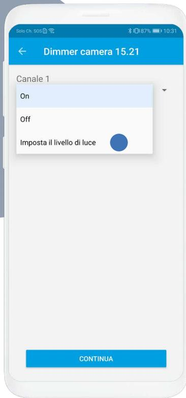
Il processo di configurazione degli scenari nel 15.71 è molto simile al 13.72. I valori possono essere ON, OFF o 'Imposta il livello di luce'.
