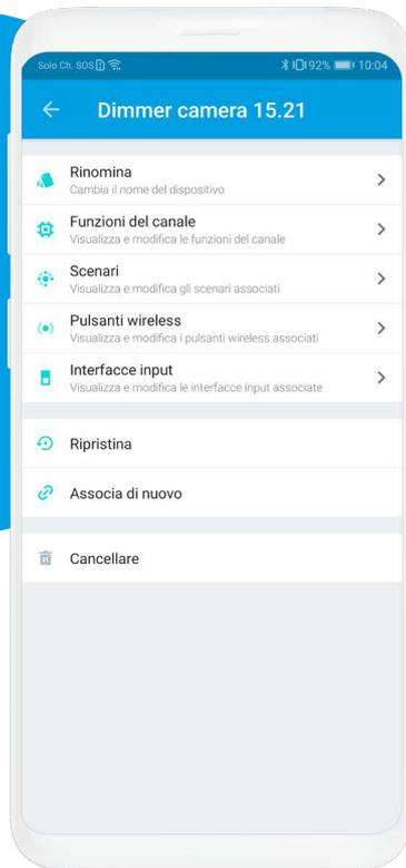
Per rimuovere un dispositivo dall'impianto esistono due modi: la rimozione semplice ed il ripristino ad impostazioni di fabbrica. Per eseguire queste operazioni, entrare nella schermata di configurazione del pezzo.
