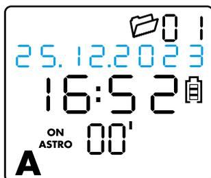
Maintenir le joystick enfoncé vers le haut pour régler la date à laquelle la fonction doit être effectuée.
